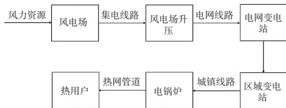
图1 蓄热电锅炉消纳弃风示意图
