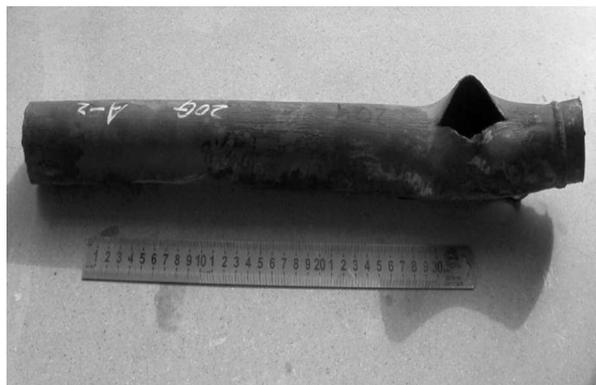
照片1 75t/h锅炉低温过热器管宏观形貌
